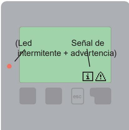
Si hay una malfunción, se activa una luz intermitente y en la pantalla aparece una señal de advertencia. Si el error desaparece, cambia la señal de advertencia a una de información y la luz se desactiva. Pulsando la tecla abajo del señal se obtiene mas información.
