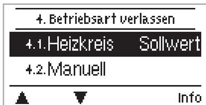
En menú “4. Modo de operación” se determinan los tipos de operación para el circuito de calefacción.
