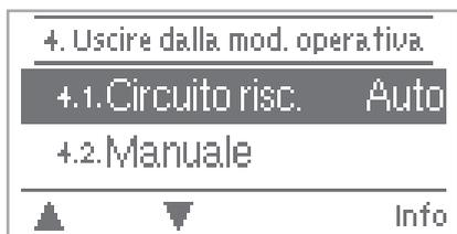
Il menu “4. modi operativi” è utilizzato per specificare il modo operativo per il circuito di riscaldamento.
