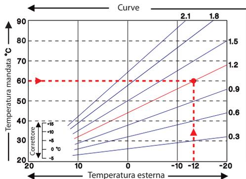
Il diagramma mostra l'influenza della pendenza della curva caratteristica selezionata (curva standard) sulla temperatura calcolata di mandata di riferimento del circuito di riscaldamento. La curva corretta è assegnata impostando il punto d'intersezione della temperatura calcolata massima di mandata e la temperatura minima esterna.
