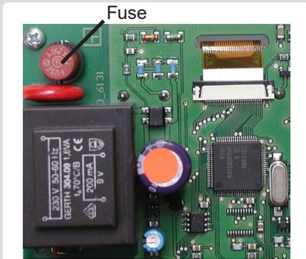
Se l'alimentazione è attiva e la centralina non funziona ancora o non appare nulla nel display, allora il fusibile interno potrebbe essere difettoso. In questo caso, aprire la centralina come descritto in C, togliere il vecchio fusibile e controllarlo.
