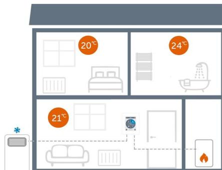
Bomba de calor con solicitud de refrigeración y solicitud de calefacción vía quemador.
