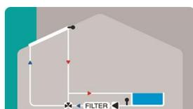
Solar con piscina, válvula de bola y bomba de filtro
