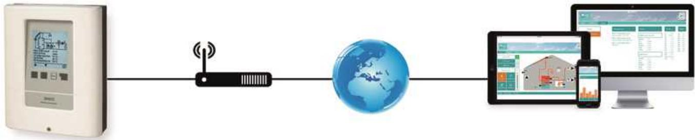
Exemplo de aplicação: XHCC com conexão de Ethernet direto
