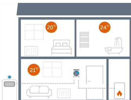
Bomba de calor com solicitação de arrefecimento e solicitação de calor pelo queimador.
