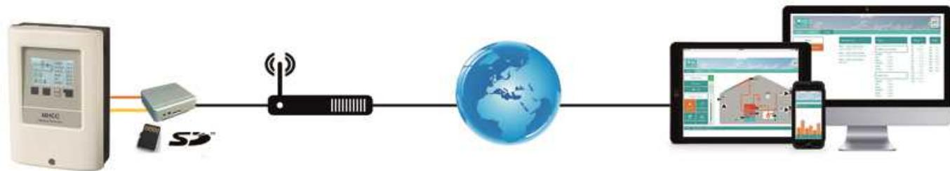
Exemplo de aplicação: MHCC com conexão Ethernet através de data logger
