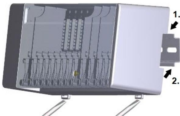
Fixez le rail DIN horizontalement au mur à l'aide de vis.
