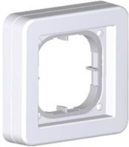
Juego de montaje compuesto por marcos de cubierta y marco de superficie. Altura total de 20 mm para uso de 55 mm de °C-Lite o sensor ambiente. Marco de plástico blanco RAL9003, 80mm x 80mm superficie mate erosionada con protección UV.
