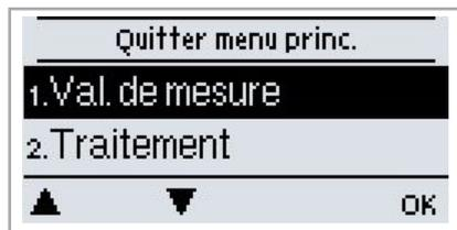
Le menu « 1. Val. de mesure » sert à afficher les températures actuellement mesurées.
