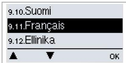
Le menu „9. - Langue“ permet de sélectionner la langue pour la commande des menus. Lors de la première mise en service, la question se pose automatiquement.
