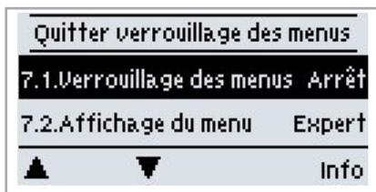
Le menu „7. - Verrouillage des menus“ permet de s’assurer que sur le régulateur les valeurs paramétrées ne soient dérégées ou modifiées involontairement.
