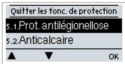
Le menu « 5. Fonctions de protection » permet d'activer et de régler diverses fonctions de protection.
