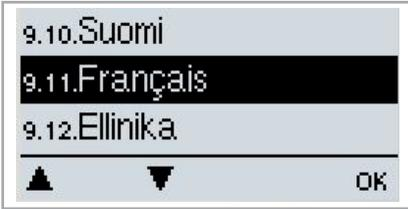
Le menu „9. - Langue“ permet de sélectionner la langue pour la commande des menus. Lors de la première mise en service, la question se pose automatiquement.
