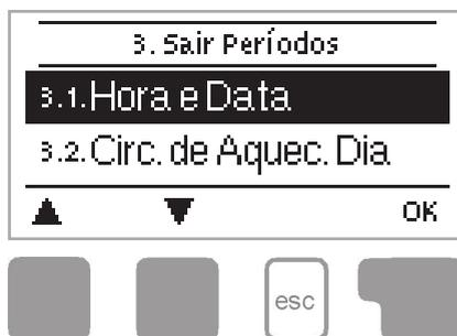
Menu “3. Tempos “é usado para definir a hora, data, horário de funcionamento para o circuito de aquecimento e água quente.
