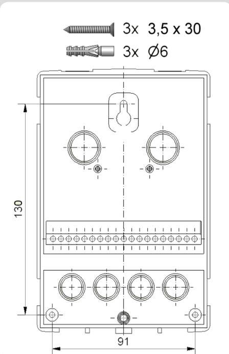
4. Segure a caixa inferior na posição desejada e marque a localização dos 3 furos a realizar. Tenha certeza que a superfície da parede está o mais possível plana para que a caixa inferior não fique torcida quando se aparafusar a caixa superior.
