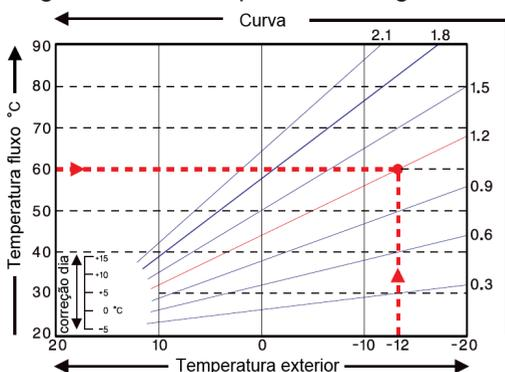
O diagrama mostra a influência do grau de inclinação da curva característica seleccionada (curva normal) no cálculo da temperatura de referência do fluxo do circuito de aquecimento. A curva correcta é escolhida pela definição pelo ponto de intercepção da temperatura máxima calculada do fluxo e a temperatura mínima exterior.
