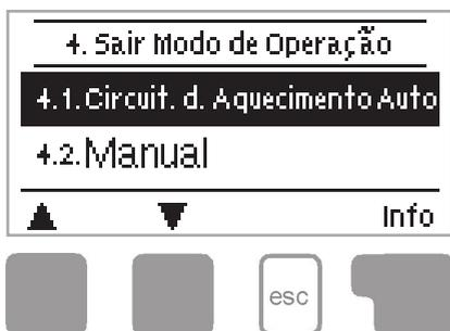
Menu “4. Modos de Operação” é usado para definir os modos de operação para o circuito de aquecimento.
