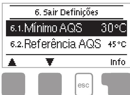
As definições básicas necessárias para a função de controlo do 2º circuito de aquecimento são efectuadas no menu “6. Definições AQS”. O menu é encerrado pressionando a tecla “Esc” ou seleccionando “Sair de Definições”.
