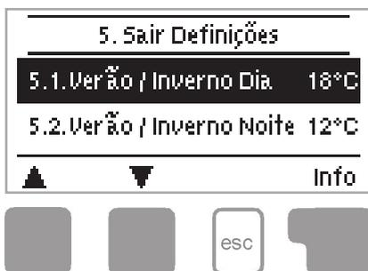
As definições básicas necessárias para a função de controlo do circuito de aquecimento são efectuadas no menu "5. Definições CA"
