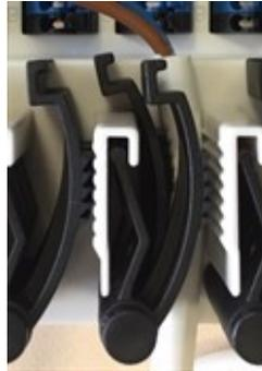
Os relevos de tensão são adequados para cabos flexíveis com uma bainha de cabo de 5mm a 8mm de diâmetro, utilizando principalmente o alívio da tensão inferior (como mostrado). Os cabos devem ser verificados. Os cabos sólidos, mais grossos e mais finos devem ser sempre fixados com firmeza e fixados ao lado da instalação.
