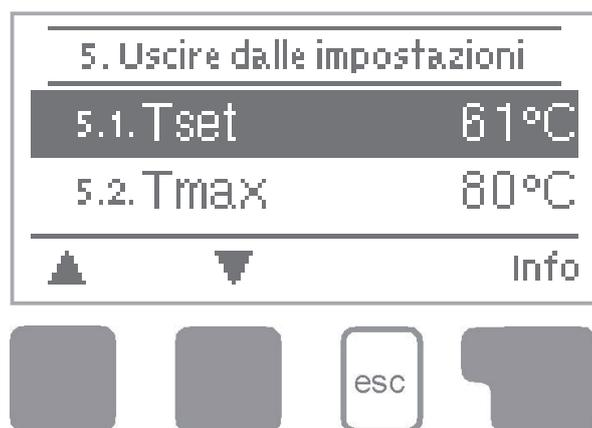
I parametri base necessari per il funzionamento della centralina sono nel menu “5. Impostazioni”.
