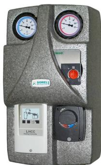
Groupe de pompes 2-voies entièrement pré assemblé et testé avec mélangeur 3-voies, Servomoteur et compensation de climat, Régulateur de chauffage LHCC et sondes
