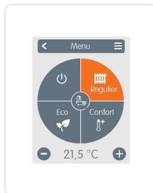
Réglez les modes de fonctionnement et la température de bien-être
