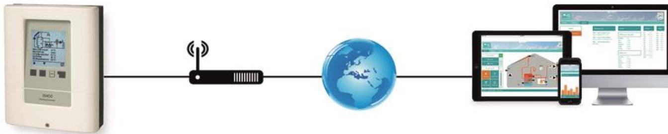
Exemple d'application: XHCC avec connexion Ethernet directe
