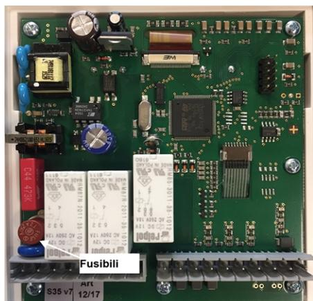
Se la tensione di alimentazione è attiva e la centralina non funziona ancora o non appare nulla nel display, il fusibile interno potrebbe essere difettoso. In questo caso, aprire il dispositivo come descritto nella sezione C, rimuovere il vecchio fusibile e controllarlo.
