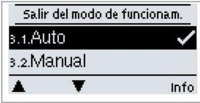
Bajo el menú “3. Modo de funcionamiento” el regulador se puede apagar, operar en automático u operar en manual.
