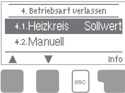
Im Menü "4. Betriebsarten" werden die Betriebsarten für den Heizkreisbetrieb festgelegt. Nach einer Netzspannungsunterbrechung kehrt der Regler selbstständig wieder in die zuletzt gewählte Betriebsart zurück! Das Menü wird durch Drücken von "esc" oder auch bei Anwahl von "Betriebsarten verlassen" beendet.
