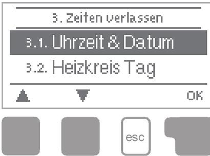
Im Menü "3. Zeiten" werden Uhrzeit, Datum und die Betriebszeiten für den Heizkreis eingestellt. Das Menü wird durch Drücken von "esc" oder auch bei Anwahl von "Anzeigemodus verlassen" beendet.
