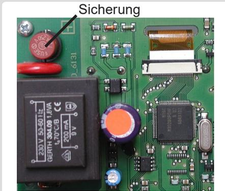
Hat der Regler trotz eingeschalteter Netzspannung keine Funktion und Anzeige mehr, so ist es möglich, dass die interne Gerätesicherung defekt ist. Dann das Gerät wie unter C beschrieben öffnen, alte Sicherung entfernen und überprüfen.
