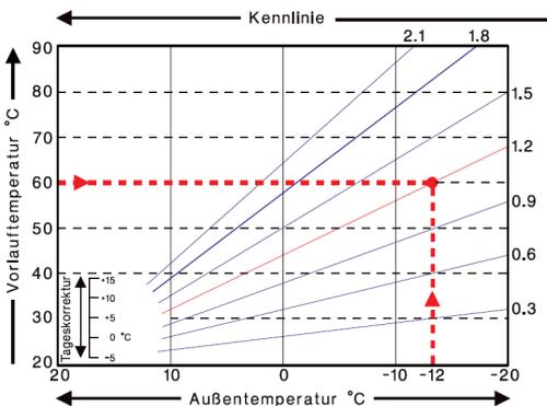
Das nachfolgende Diagramm zeigt den Einfluß der gewählten Kennliniensteilheit (Normal-Kennlinie) auf die errechnete Sollvorlauftemperatur des Heizkreises. Die richtige Kennlinie wird bestimmt, indem man den Schnittpunkt der berechneten maximalen Vorlauftemperatur (= Auslegungstemperatur) bei minimaler Außentemperatur festlegt.
