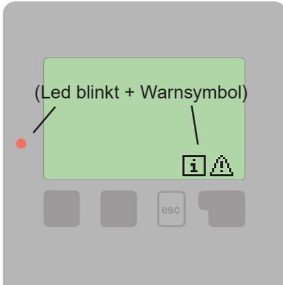
Erkennt der Regler eine Fehlfunktion, so erscheint das Warnsymbol im Display. Liegt der Fehler nicht mehr an, ändert sich das Warnsymbol in ein Infosymbol. Nähere Informationen zum Fehler erhalten Sie durch Drücken der Taste unter dem Warn- bzw. Infosymbol.
