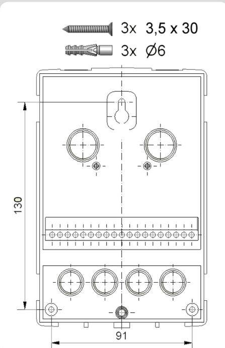
5. Mittels Bohrmaschine und 6er Bohrer 3 Löcher an den angezeichneten Stellen in die Wand bohren und die Dübel eindrücken.
