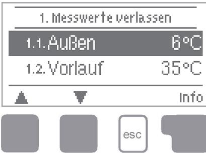
Das Menü "1. Messwerte" dient zur Anzeige der aktuell gemessenen Temperaturen und der Luftfeuchtigkeit, sowie zur Anzeige der Einstellung des Raumcontrollers.
