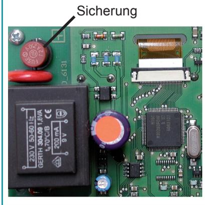
Hat der Regler trotz eingeschalteter Netzspannung keine Funktion und Anzeige mehr, so ist es möglich, dass die interne Gerätesicherung defekt ist. Dann das Gerät wie unter „C.1. - Wandmontage“ auf Seite 8 beschrieben öffnen, alte Sicherung entfernen und überprüfen. Die defekte Sicherung wechseln, externe Fehlerquelle (wie z.B. Pumpe) finden und austauschen.
