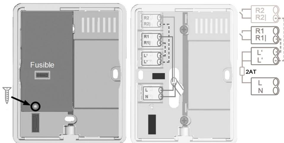
Desatornillar el tornillo, quitar la cubierta del cable y conectar el eléctrico como es descrito.
