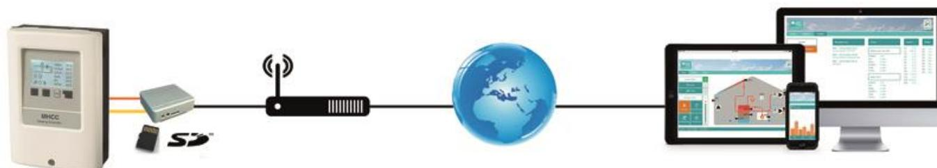
Esempio di applicazione: MHCC con connessione Ethernet tramite data logger
