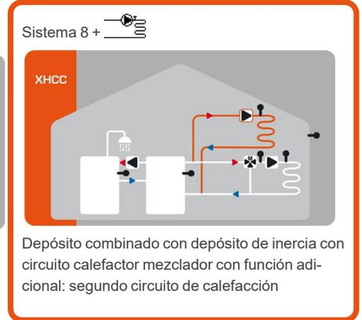
Depósito combinado con depósito de inercia con circuito calefactor mezclador con función adicional: segundo circuito de calefacción
