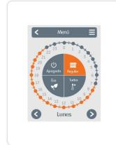
Paso 2 Seleccione el primer modo de calefacción (Normal) - con el dedo índice seleccione el período deseado. El período seleccionado es coloreado al seleccionar el color del modo de funcionamiento (Normal = Naranja).
