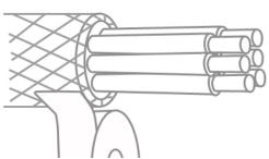
Pelar cables, deslizar el conductor de protección, y eliminar el material de relleno según sea necesario.
