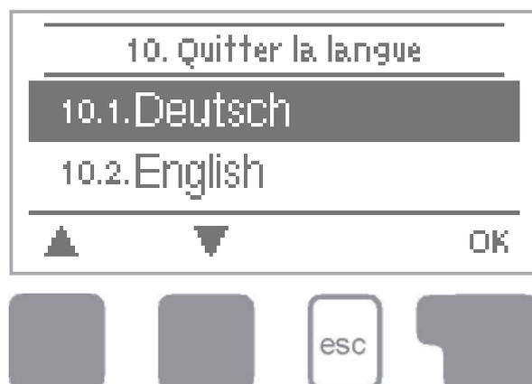
Le menu « 10. Langue » permet de sélectionner la langue de l'interface. Lors de la première mise en service, la demande de sélection est automatique.
