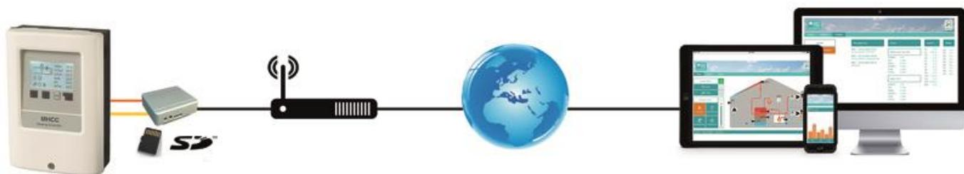
Exemple d'application: MHCC avec connexion Ethernet directe avec enregistreur de données
