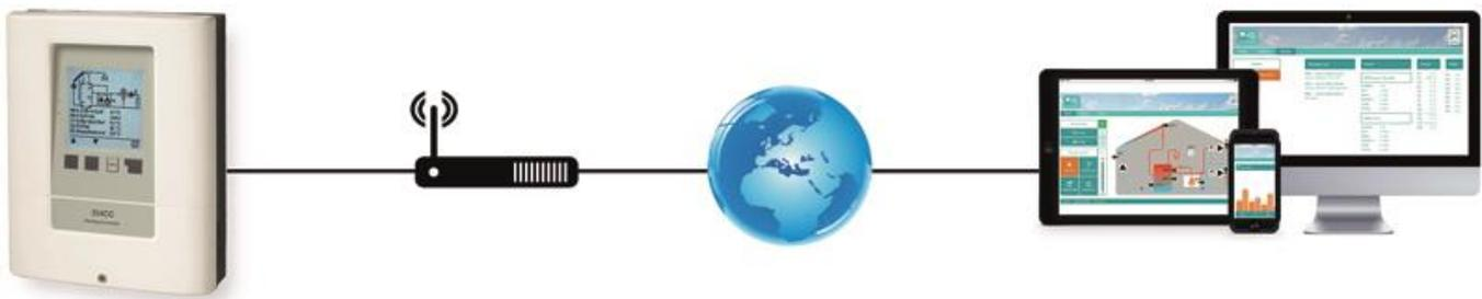
Exemple d'application: XHCC avec connexion Ethernet directe
