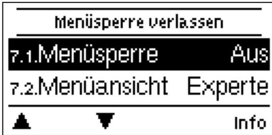
Durch aktivierte Menüsperre können die eingestellten Werte gegen unbeabsichtigtes Verstellen gesichert werden.
