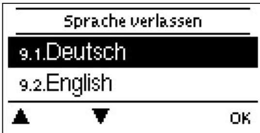
Zur Wahl der Menüsprache. Bei der ersten Inbetriebnahme und bei längerer Spannungsunterbrechung erfolgt die Abfrage automatisch.
