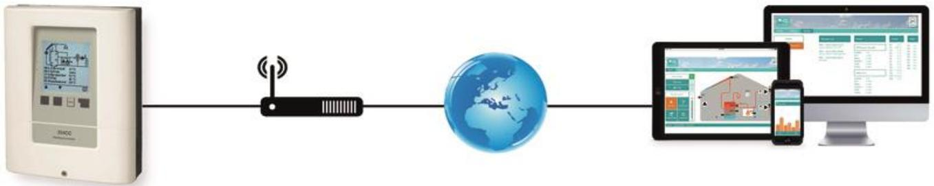
Exemple d'application: XHCC avec connexion Ethernet directe
