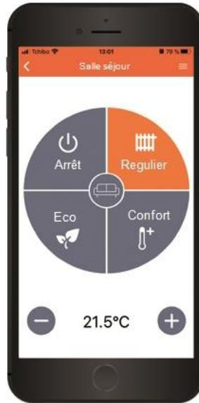
Sélectionner le mode de fonctionnement et fixer la température ambiante cible
