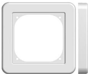
Cadre de finition pour les inserts de 55 mm de la sonde d'ambiance SOREL ou °C-Lite. Cadre en plastique blanc pur RAL9003, surface érodée mate de 80 mm x 80 mm avec protection UV.
