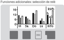
Una grabación de los datos permite el con-trol de la función y una supervisión a largo plazo del sistema.
