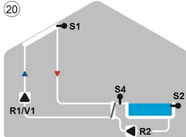
20 Solar mit Pool und Wärmetauscher
