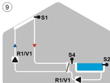
Solar mit Wärmetauscher und Pool
