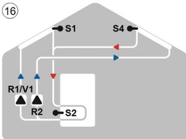
16 Solar mit 2 Kollektoren und 2 Pumpen
