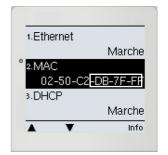
3.Dans le menu du régulateur vous allez dans Fonctions spécifiques - Ethernet-Contrôle utilisateur et choisissez un des 4 positions disponibles et faites OK. Pendant le stade suivant essayant d'établir la connexion, le menu affiché doit rester ouvert.
