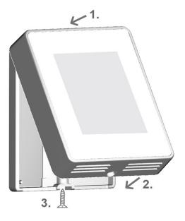
Rimontare la base e avvitare. Accendere l'interruttore generale per ricollegare la corrente e mettere in funzione il °CALEON.
