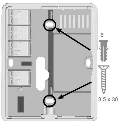
Abra los terminales con la herramienta incluida y haga la conexión eléctrica como se describe.
