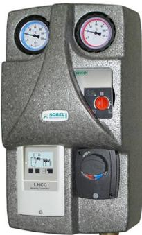
Komplett vormontierte und geprüfte 2-Wege Pumpengruppe mit 3-Wege-Mischer, Servomotor und witterungsgesteuertem Heizungs Controller LHCC inkl. Fühlern
