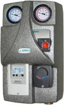
Komplett vormontierte und geprüfte 2-Wege Pumpengruppe mit 3-Wege-Mischer, Servomotor und witterungsgesteuertem Heizungs Controller MHCC inkl. Fühlern
