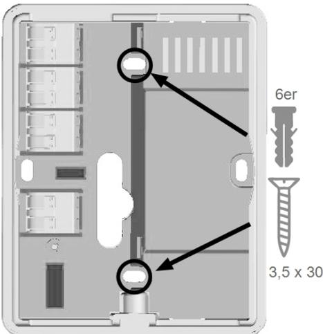
Montieren Sie das Gerät an geeigneter Stelle.
